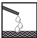
Конденсат не должен попадать в прибор. При минусовых температурах возможны сбои/ выходы из строя вследствие обледенения.
